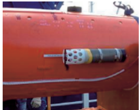
AE2000fに搭載したPHセンサ
